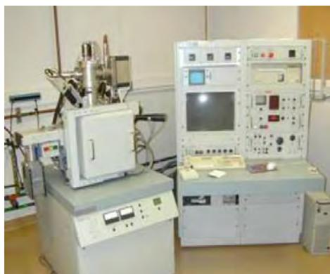
Figura: Máquina de haces de iones focalizados (FIB)
