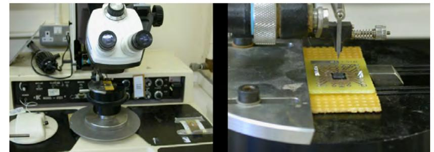
Figura: Cableado para medida del consumo de potencia del chip
