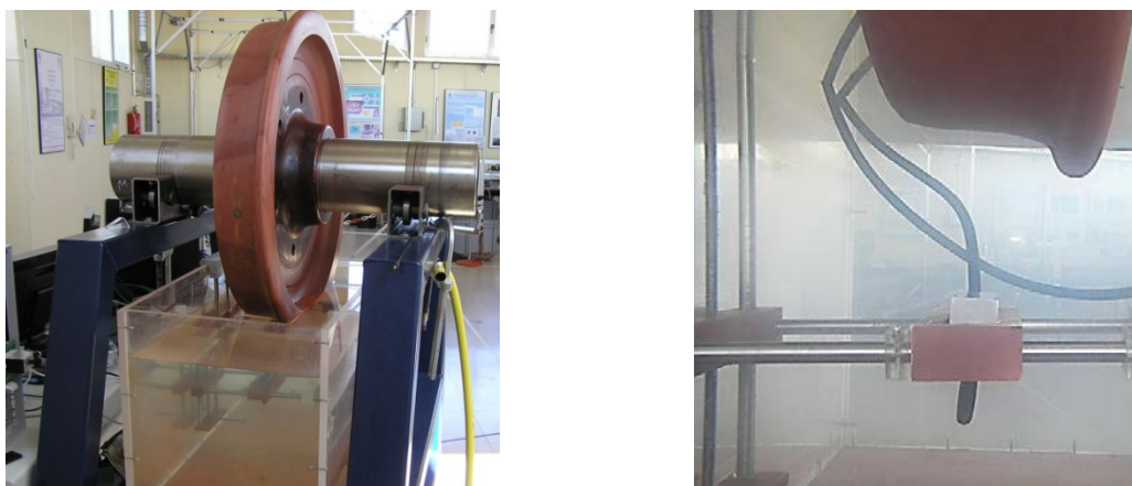
Figura 1. Imagen del banco de medida y detalle de la colocación del array.
