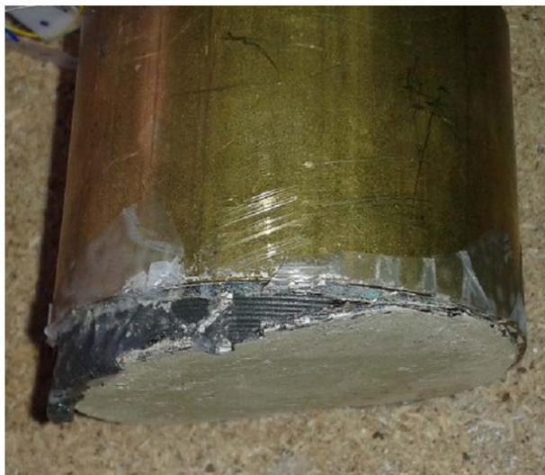
Figura 4.4: EF3: disco inferior separado de la estructura superior.
