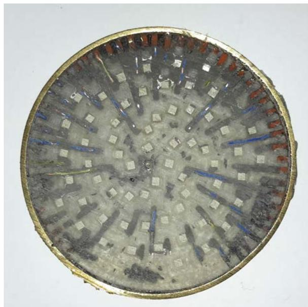
Figura 4.3: EF2: corte longitudinal del disco; se puede observar los canales del cableado inundados de material de backing conductivo.
