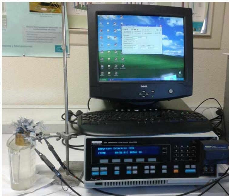
Figura 4.6: Montaje experimental para la medida de impedancias con el equipo analizador.
